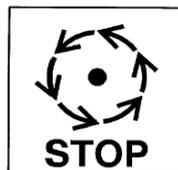
Attendre l'arrêt complet de la rotation des couteaux avant toute action sur le broyeur
