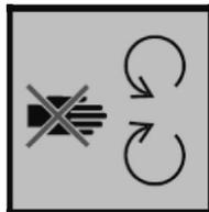
Danger : lames rotatives. Gardez les pieds et les mains hors des ouvertures pendant le fonctionnement de la machine.
