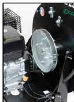
Entraînement du rotor par une courroie.
